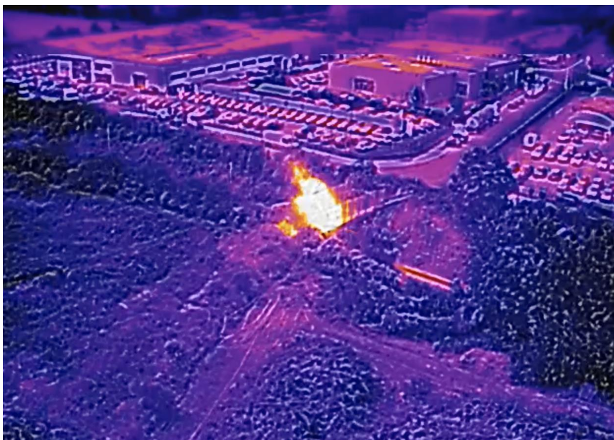
L'emploi d'un drone équipé d'une caméra thermique permet de visualiser la fuite grâce au flux thermique © SDIS 95
